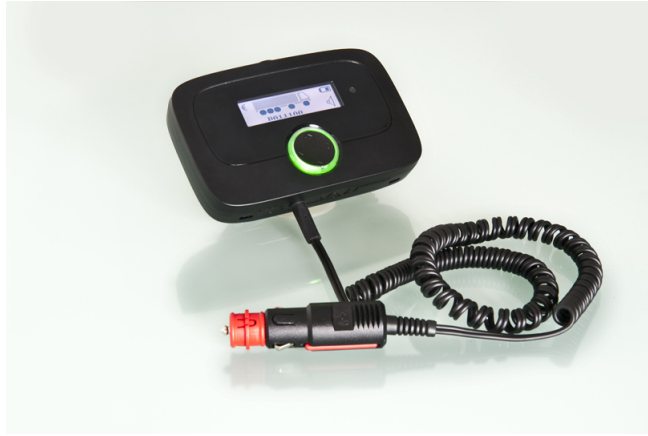
Illustration d'un boîtier embarqué SkyTOLL
